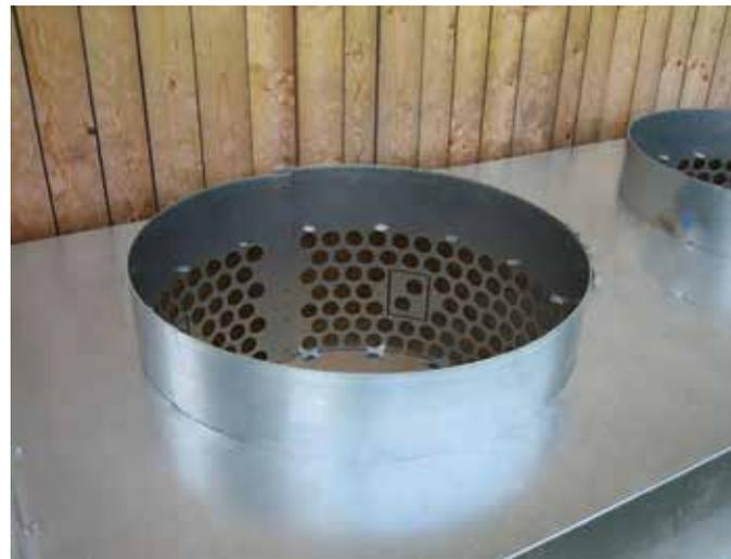
Bis ins kleinste Detail durchdacht: Unsere Bodenkalttrocknung sowie das Kombi-Flex-System verfügen standardmäßig über Luftbremsen. Diese sorgen bei langen Luftkanälen für gleichmäßige Luftgeschwindigkeiten. Essenziell wenn alle Rundballen gleichzeitig trocken sein sollen.
