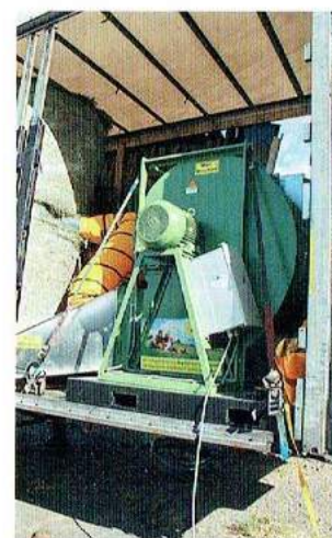
Auf der mobilen Trocknung von Burdorf sind ein Gebläse und ein Wärmetauscher installiert.
