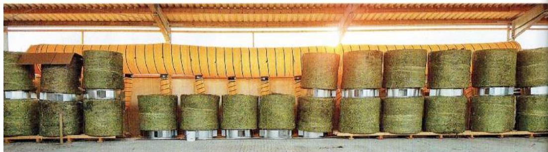
Vom Schlauchkanal oben zweigen Schläuche zu den Belüftungsrings ab. An jedem Abgang gibt es einen Schieber, der diesen bei Bedarf verschließt.
