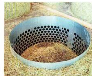
Durch solche Lochringeinsätze gelangt die Luft aus dem Bodenkanal in den Ballen.
