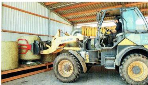
Um die Ballen mit der Ballenzange genau passend auf die Ringe setzen zu können, muss zwischen den Ballen genug Platz sein.
