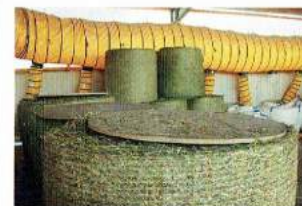
Die Abdeckung auf dem Ballen verhindert, dass die Luft zu schnell durch den Ballen strömt.
