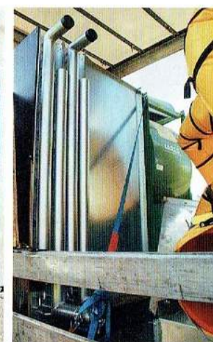
Auf der mobilen Trocknung von Burdorf sind ein Gebläse und ein Wärmetauscher installiert.
