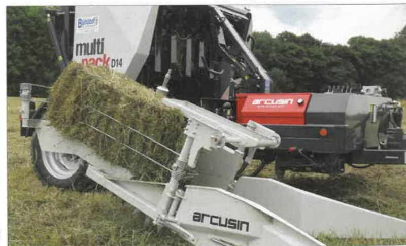
Für die spätere Trocknung lassen sich die kleinen Hochdruckballen in einem gebundenen Quaderballen, zum Beispiel mit einem Arcusin D 14 System, weiter verarbeiten. Dieser kann Pakete mit 10, 12 oder 14 HD-Ballen herstellen.
