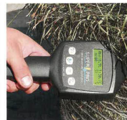
Während des Trocknens sollten mehrmals täglich die Temperatur und die Feuchte im Ballen überprüft werden.
