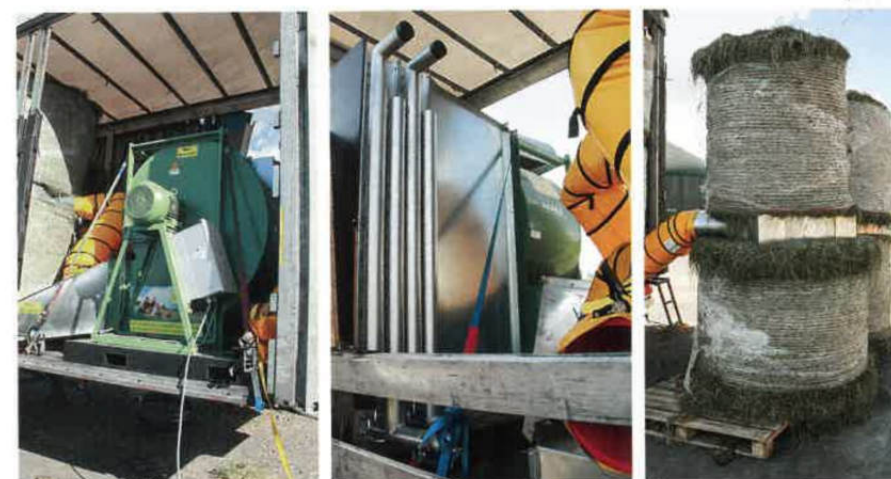
Auf der mobilen Trocknung von Burdorf sind ein Gebläse und ein Wärmetauscher installiert.
